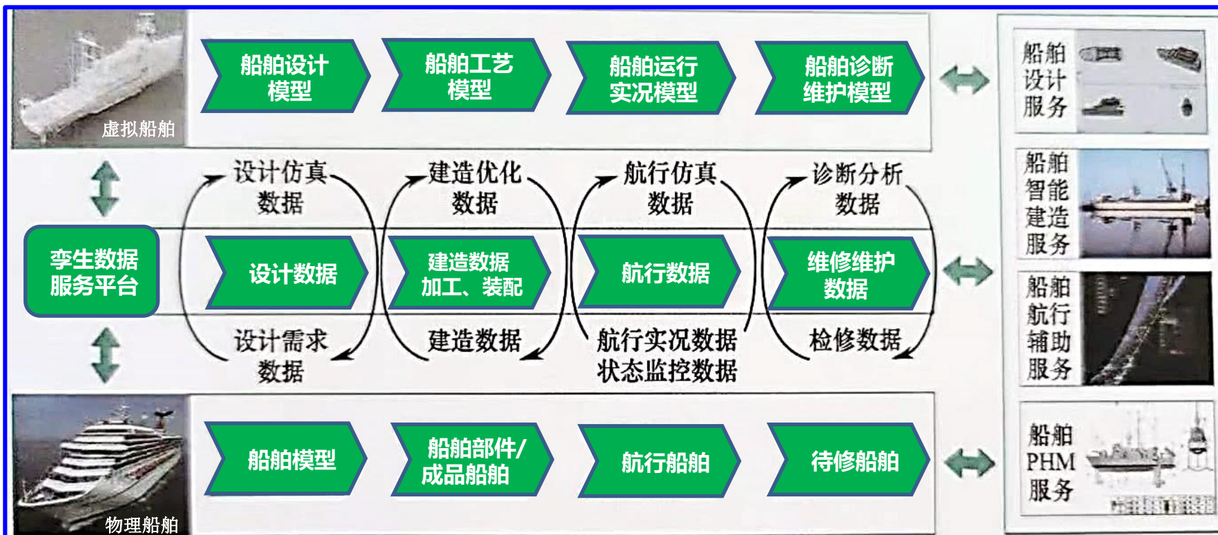
数字孪生船舶全生命周期管控模型示意图
