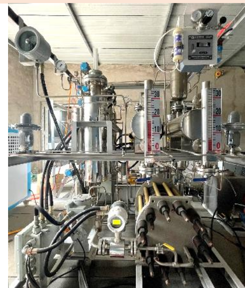
全球首台10kW连续直接海水电解制氢系统及其运行机制
