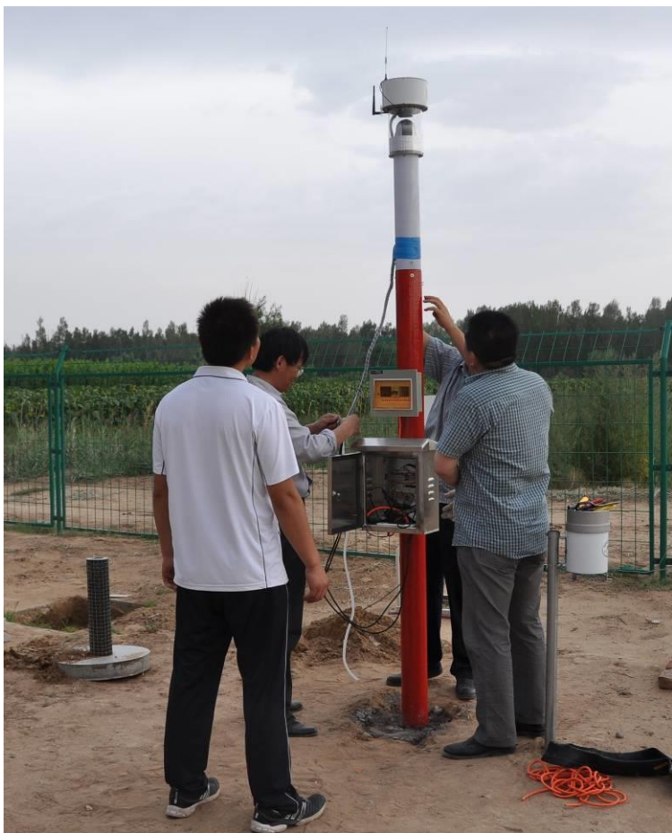
无线传感网络野外安装
