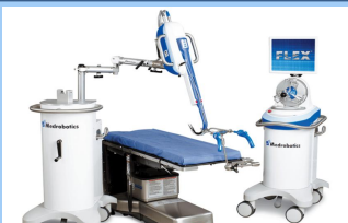
美国Medrobotics公司开发的Flex机器人系统是一种高度铰接、多链接的“蛇形”机器人，获得了FDA认证。
