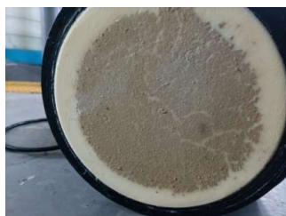
超滤产水端面污堵情况
