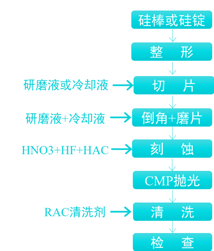
光伏硅片生产工艺流程图
