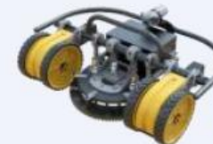
高压水回收除锈机器人
