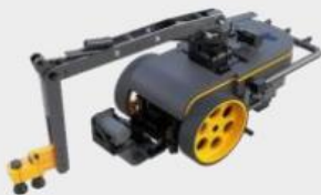
罐内防腐机器人
