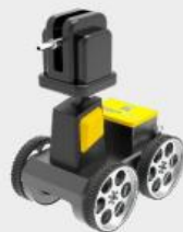
货舱清洗机器人
