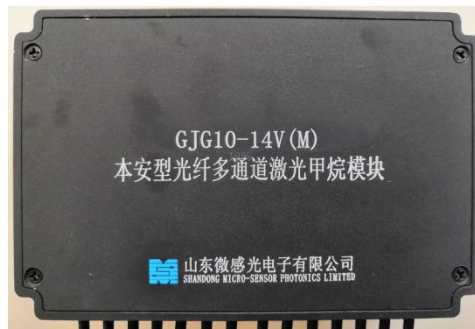
GJG10-14V(M) 本安型光纤多通道激光甲烷模块
