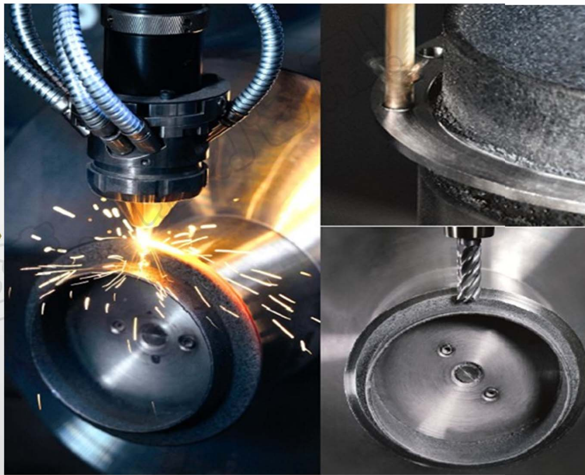
增材加工 + 切削(减材)加工
