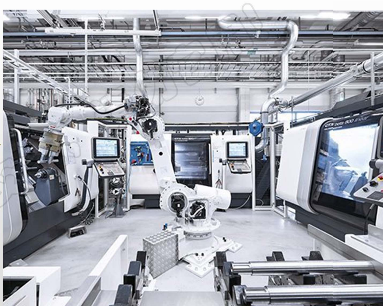
“机床+机器人+AGV+中央刀库”构成加工单元协同工作
