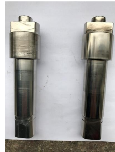
阀杆的工况模拟测试
