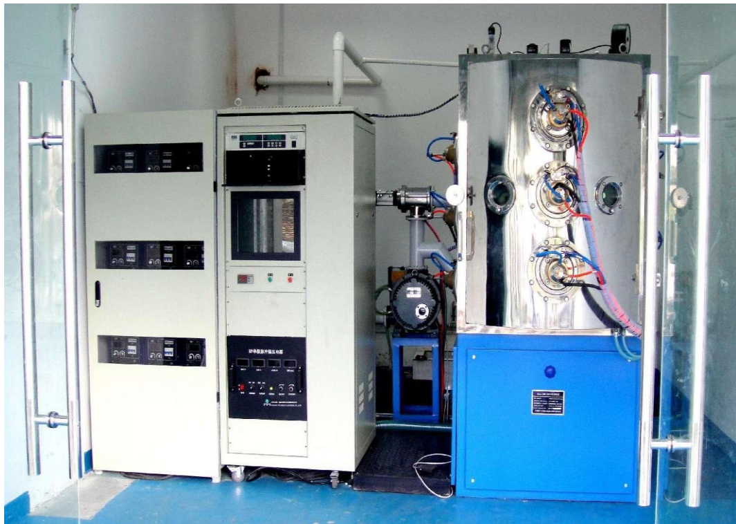
超硬耐蚀涂层在球阀球体上的应用及装置
