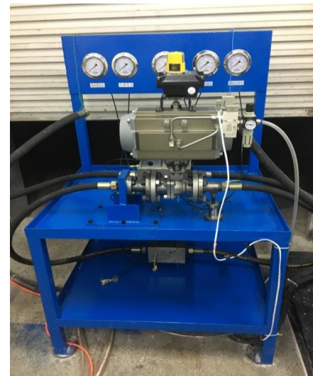
阀杆的工况模拟测试
