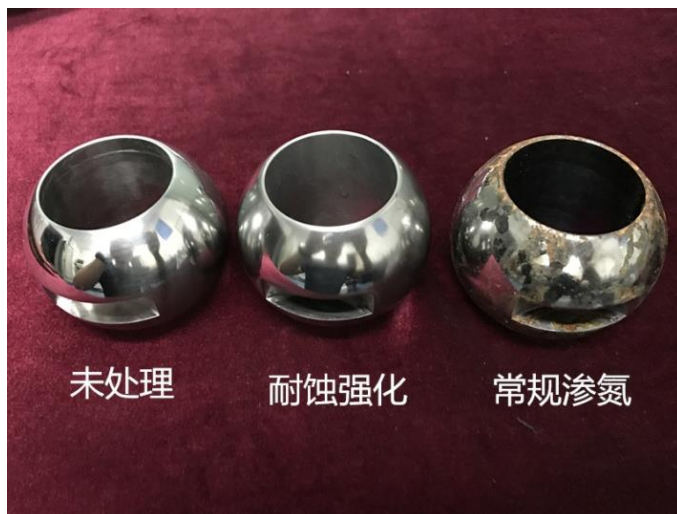
渗氮硬化处理与耐蚀 强化处理球体和阀杆
