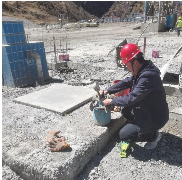
混凝土坍落度检测及含气量检测
