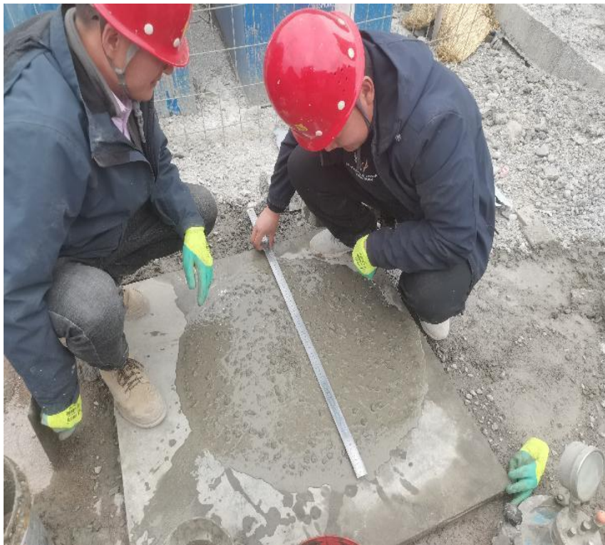
混凝土坍落度检测及含气量检测
