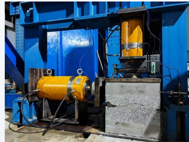
层面剪切强度试验
