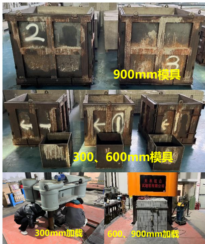
立方体抗压强度尺寸效应试验
