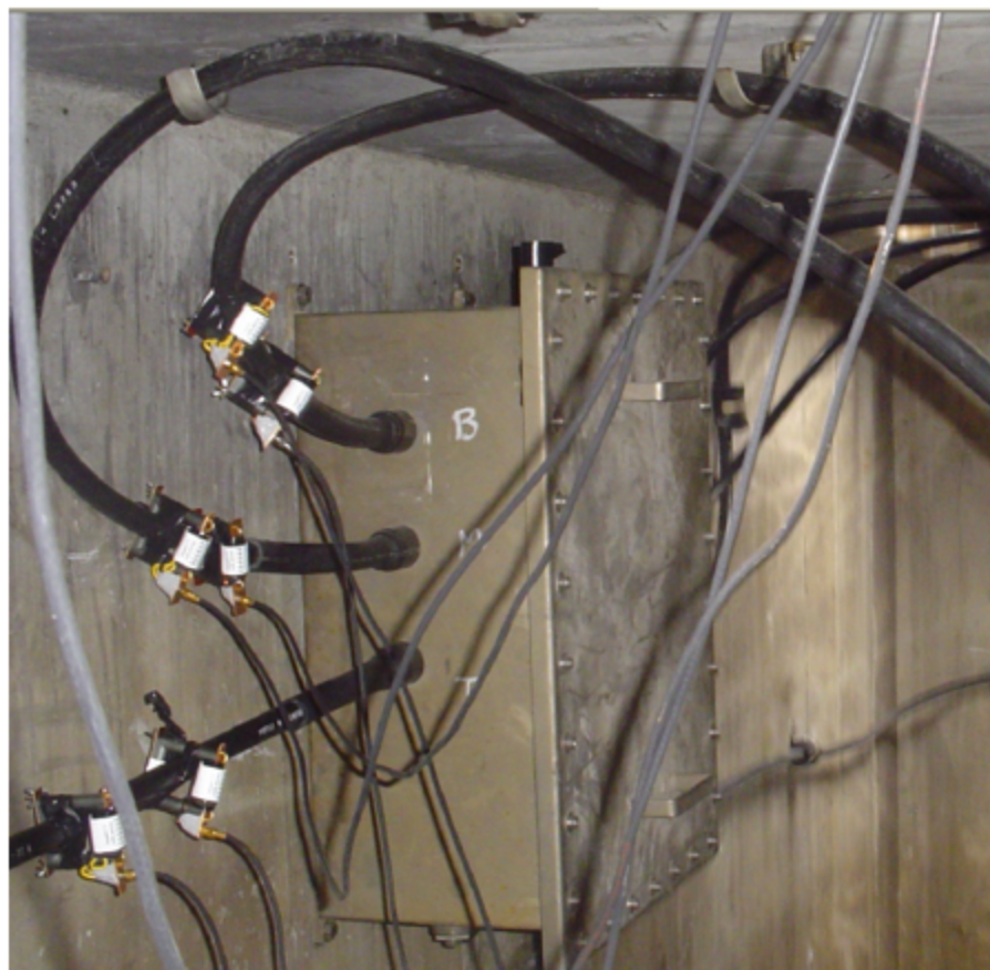
□ 图b16-3 电磁耦合法的电流传感器安放位置图
