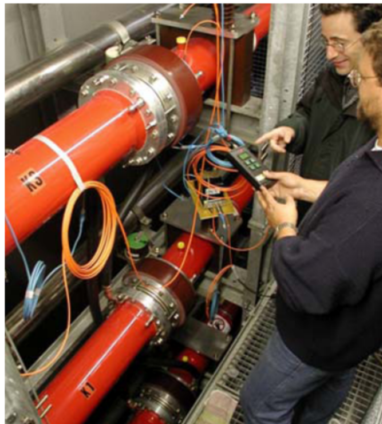
□ 图b16-3 电磁耦合法的电流传感器安放位置图
