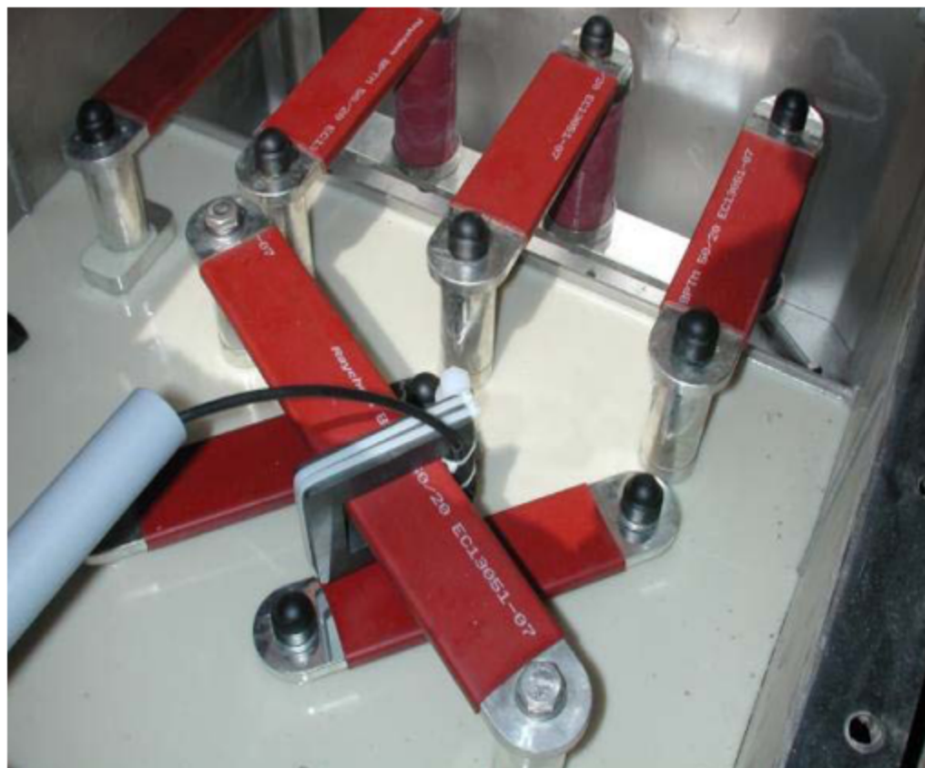
□ 图b16-4 电磁耦合法的电流传感器安放位置图
