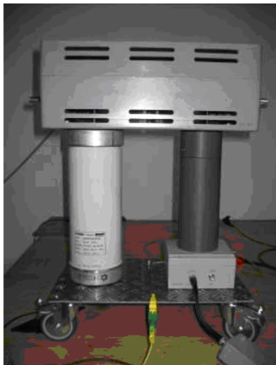
图g2 PD30/PD60电缆局放故障定位系统实物图片
