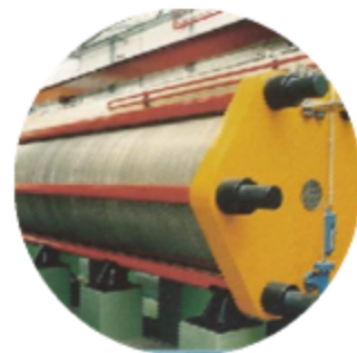
2020年国外某公司760Nm 3 /h压力型电解槽
