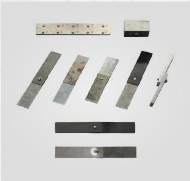
多种材料、多层厚度铆接 (E-TOX, E-SP, E-穿刺铆接)
