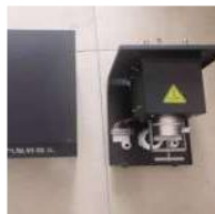
采样探头 除尘过滤、加 热保温以避免 水冷凝
