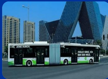
储能式现代有轨电车 超快充30s充满；制动能量回收>20%
